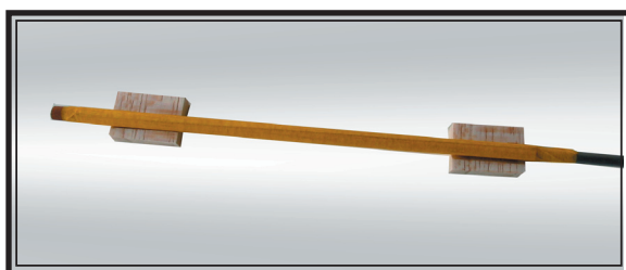
Balsa navinutá na trnu s pomocným papírem
