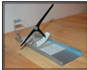
Přípravek pro měření stoupání vrtule
