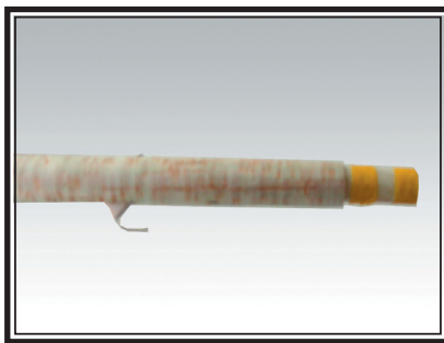
zadní část motorstiku F1D, konická spojovací trubka.
