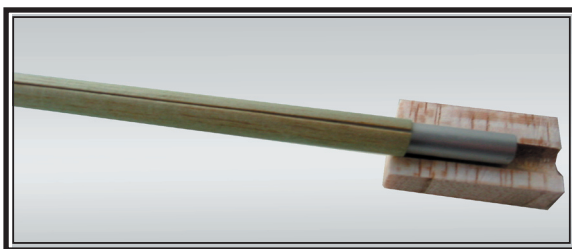
Slepování balsové trubky na trnu
