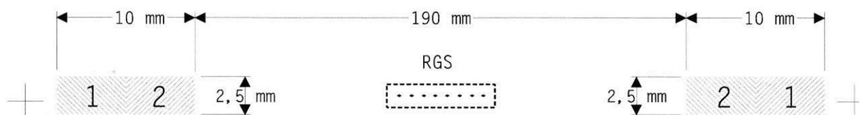
Die Kontrollelemente sind gem. Druckcharakter in den Feldern 1 und 2 angeordnet. Sie haben eine Breite von 2,5 mm. Diese Felder werden durch MAFRAPRINT Druckereien genutzt. Standardmäßig sind die Elemente im Feld 1 angeordnet.
